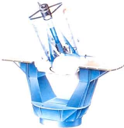
Figura 12 (dcha) - Esquema del telescopio William Herschel, que dispone de montura de norquilla altazimutal. Se ilustra también la localización del foco Nasmyth.
