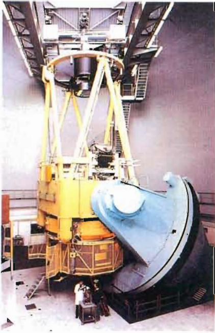
Figura 10 (izq). - Telescopio de 3.6 metros del Observatorio de La Silla en Chile. Proporciona un buen ejemplo de montura ecuatorial en forma de horquilla. Figura 11 (dcha). - Ejemplo de un foco Coudé practicado en una montura inglesa modificada (adaptado de Kitchin 1984).
